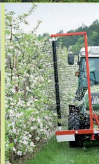
Механічний проріджувач зав'язі моделі Darwin виробництва Німеччини
