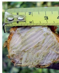
Фото 4. Ріжучі сегменти здатні працювати з гілками діаметром до 35–40 мм
