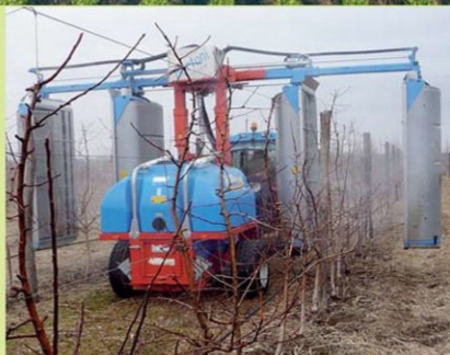
Тунельні обприскувачі для садів та виноградників економлять у середньому 50% засобів захисту, виробництва Італії
